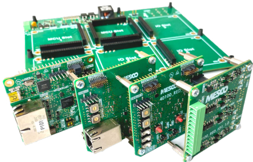
Abb3: Möglicher Einsatz von MESCO Design Packages bei der Feldgeräte-Entwicklung oder zum Rapid-Prototyping
